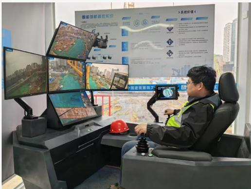
太古地产率先在西安太古里使用遥控塔式起重机系统，大大提高施工安全和效率。起重机操作人员可在地面运用人工智能作业，毋须登上塔架，消除了重大安全隐患。操作人员可在场内安全的驾驶室操控起重机。
